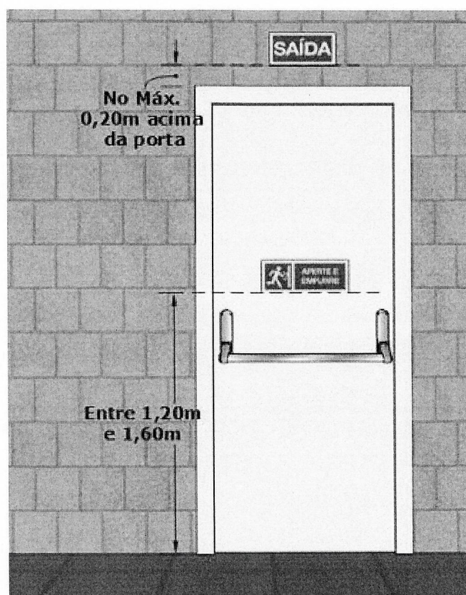
Figura 3 - Sinalização de porta de saída de emergência e sinalização de abertura da porta por barra antipânico. (ver sinalizações de códigos S12, S14 e S18)
