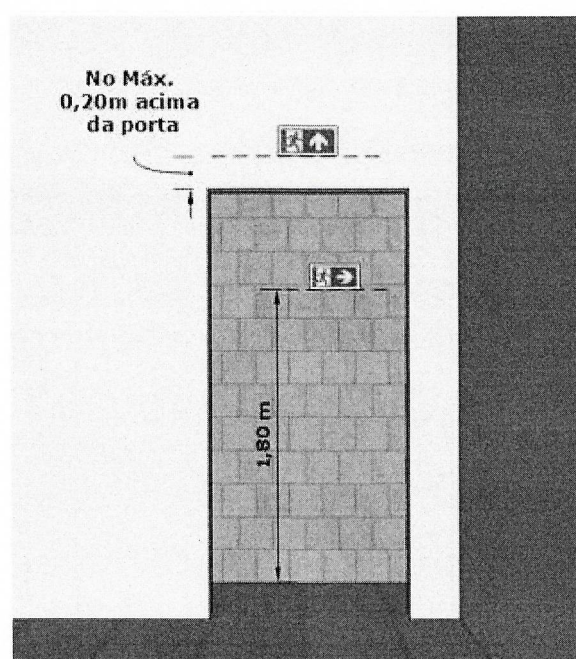
Figura 2 - Sinalização do sentido da rota de fuga. Em primeiro plano, sinalização de vão de abertura sem a folha da porta. (ver sinalizações de códigos S1 a S15-E)
